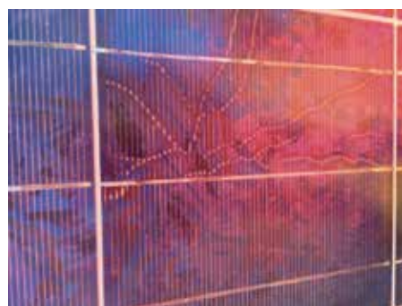
Solarzellen mit Hot Spots
