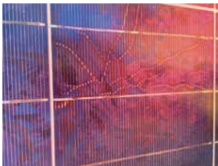
Solarzellen mit Hot Spots
