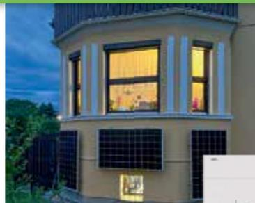
Die Firma NETZING hat jetzt auch Kleinanlagen 600/800 W zum direkten Anschluss an das Stromnetz **NEU** im Angebot, sogenannte Balkon-Solaranlagen mit Microwechselrichtern.
